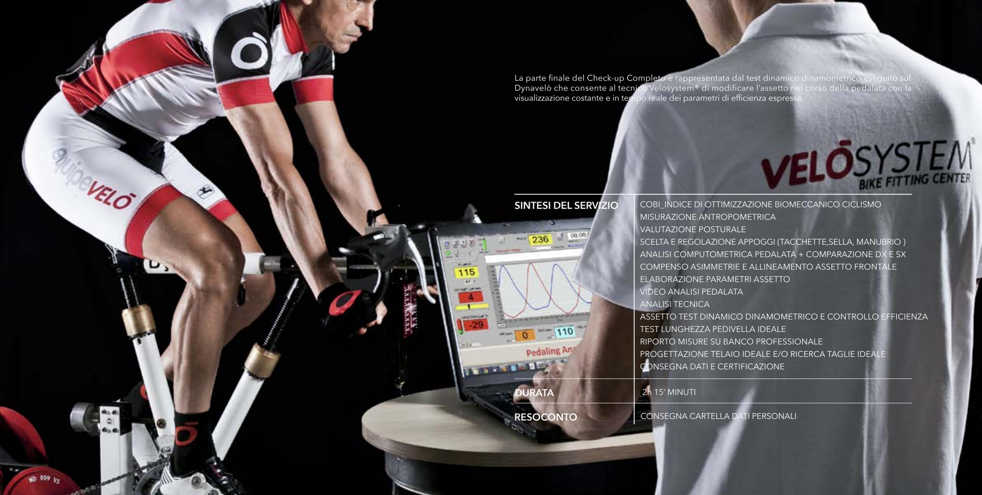
La parte finale del Check-up Completo è rappresentata dal test dinamico dinamometrico eseguito sul Dynavelò che consente al tecnico Velosystem® di modificare l'assetto nel corso della pedalata con la visualizzazione costante e in tempo reale dei parametri di efficienza espressa.
